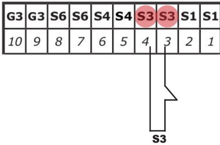
**Conexiones para esquema 0 y Kit de ACS**
