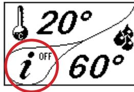
En esta condición, pulsando la tecla CONFIRMAR se puede leer el detalle del aviso: «Puertas y cajón de ceniza abiertos». Si la puerta de la cámara de combustión y/o el cajón de ceniza no se cierran en 1 minuto, la estufa se apaga, señalizando la ALARMA 07. La apertura de las puertas también interrumpe la fase de limpieza automática del brasero. En caso de una interrupción prolongada de la fase de limpieza, puede aparecer la ALARMA 19.
