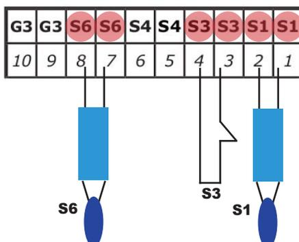
**Conexiones para esquema 3 (depósito de ACS + puffer)**
