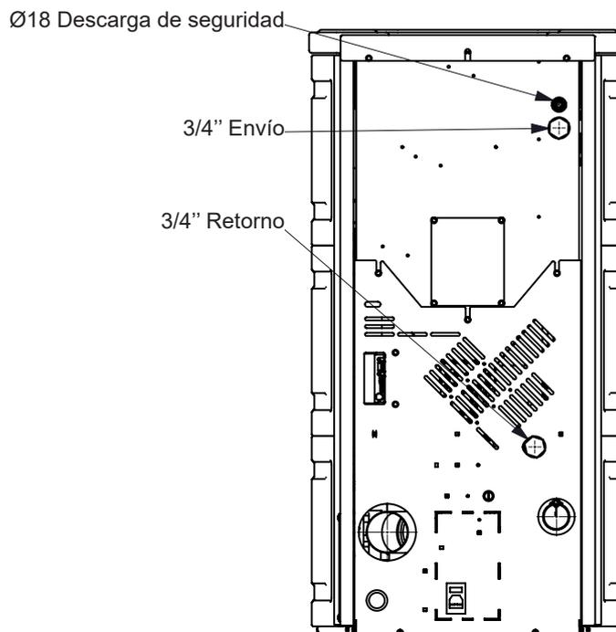
Conecte la estufa a la instalación hidráulica de manera que no se vincule excesivamente, para que pueda realizar ligeros desplazamientos.
