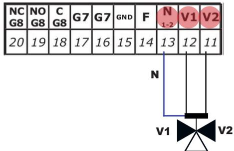
**Conexiones para esquema 1 (depósito de ACS)**
