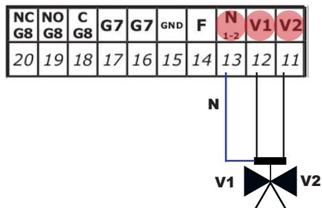
**Conexiones para esquema 2 (puffer)**
