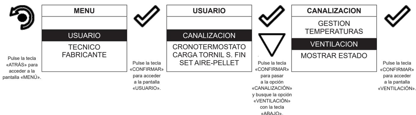
Una vez que haya accedido a la opción «VENTILACIÓN», verá la siguiente pantalla: la línea superior de la pantalla muestra la potencia de la ventilación delantera, mientras que la línea inferior de la pantalla muestra la posibilidad de acceder a los siguientes ajustes (posterior derecha y posterior izquierda).
