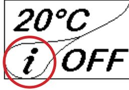
En esta condición, pulsando la tecla CONFIRMAR se puede leer el detalle del aviso: «Puertas y cajón de ceniza abiertos». Si la puerta de la cámara de combustión, la tapa del depósito de pellets y/o el cajón de ceniza no se cierran en 1 minuto, la estufa se apaga, señalizando la ALARMA 07.
