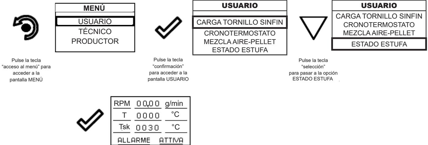
En este menú se puede comprobar el funcionamiento correcto de los parámetros más importantes del aparato. Abajo se presenta una lista de datos reales de la estufa útiles durante la fase de control.
