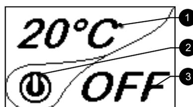
Después de 5 minutos de inactividad, el display del mando a distancia se oscurece y pasa al modo "SLEEP", aun manteniendo la conexión inalámbrica con la estufa. Al pulsar nuevamente la tecla ON / OFF, la pantalla vuelve activarse.
