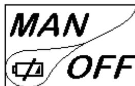
Apenas el nivel de batería no permite bajo ningún concepto la comunicación radio, el dispositivo muestra en la pantalla completa la imagen de la batería descargada, bloqueando todas las funciones del dispositivo hasta que se produzca la sustitución de las baterías.
