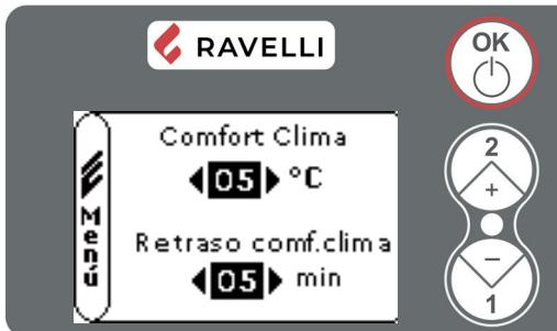
La activación de esta función permite reducir la carga de pellet cuando se alcanza la temperatura deseada, activando la fase de modulación. Luego, la estufa comprueba que la temperatura se mantiene durante un período de tiempo (RETRASO C.CLIMA) y, si lo hace, se apagará automáticamente, mostrando la inscripción ECO STOP en la pantalla.
