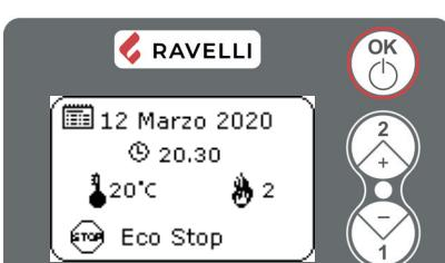
Terminada la fase de apagamiento la pantalla visualizará la fase de ECO STOP. La estufa queda en este estado hasta que la temperatura baje a 15°C, en este momento va a empezar la fase de encendido.
