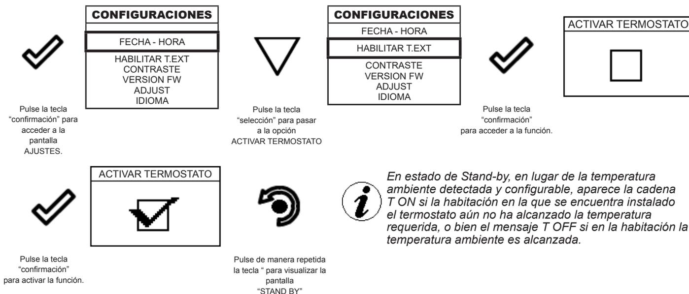
*En estado de Stand-by, en lugar de la temperatura ambiente detectada y configurable, aparece la cadena T ON si la habitación en la que se encuentra instalado el termostato aún no ha alcanzado la temperatura requerida, o bien el mensaje T OFF si en la habitación la temperatura ambiente es alcanzada.*
